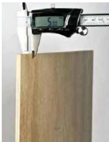
Exemple de panneau/dalle de carreau de porcelaine calibré d'une épaisseur de 5 mm
