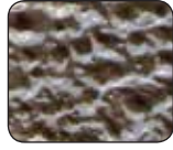
Effet de peau d'orange avec Additix PE
