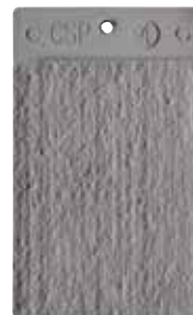
CSP 4 : Scarification légère
