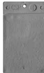
CSP 1 : Décapage à l'acide
