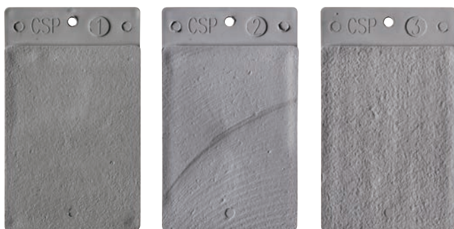
CSP 1 : Décapage à l'acide
