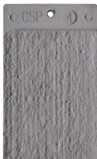
CSP 4 : Scarification légère
