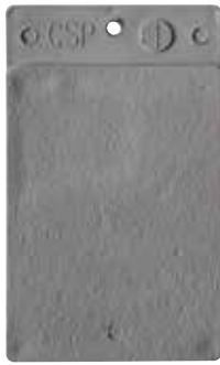
CSP 1 : Décapage à l'acide
