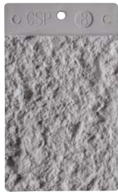
ICRI CSP 8: Escarificado
