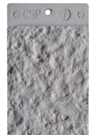
ICRI CSP 7: Chorro de alta abrasión
