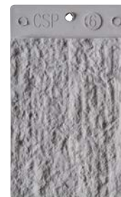
ICRI CSP 6: Escarificación media
