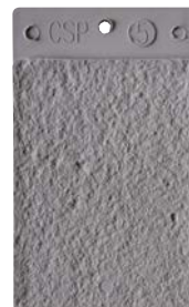
ICRI CSP 5: Granallado medio
