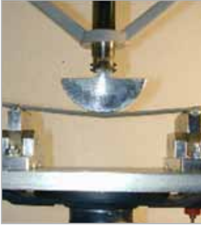
Fig. 4.7 – Prueba a flexión de los adhesivos según la EN 12004
