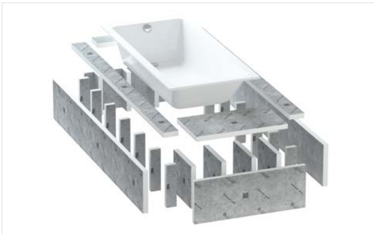
Realização de uma envolvente de banheira
