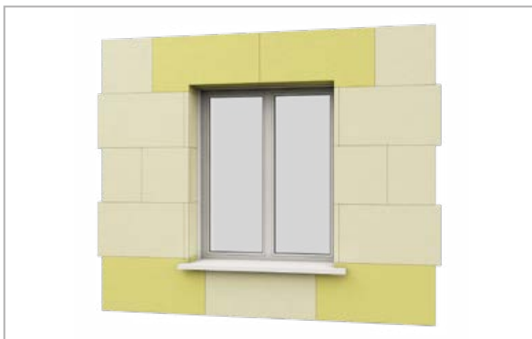
Aplicação correta dos painéis na proximidade das aberturas
