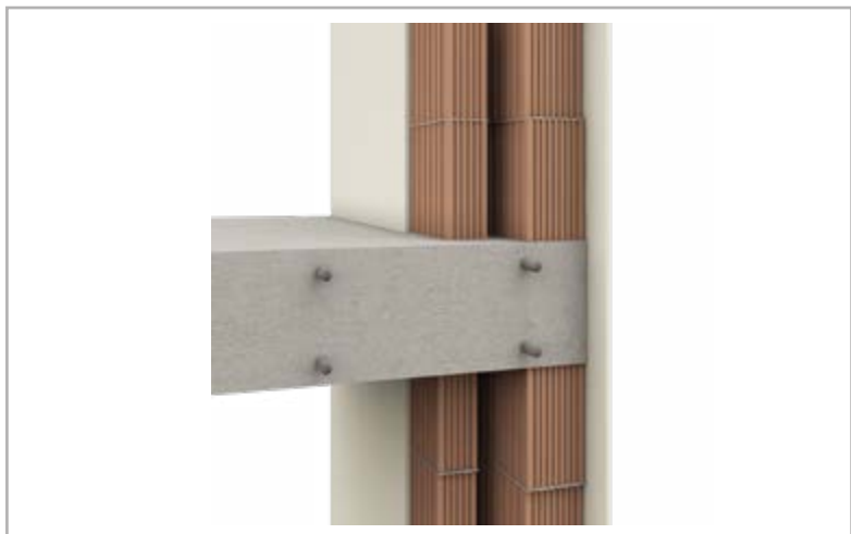
Estratigrafia da estrutura não isolada
