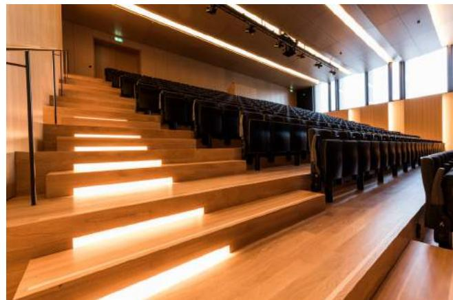
bois. Finalement, deux couches (180 g/m<sup>2</sup>) du vernis polyuréthane bicomposant ULTRACOAT HIGH TRAFFIC ont été appliquées. Il s'agit d'un vernis à très faible émission, certifié EC 1 R Plus. Très résistant à l'usure et à l'abrasion, il convient parfaitement aux bâtiments publics à charge élevée et donc aussi à des salles de classe.
