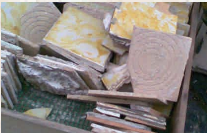
Rodapé retirado e sucessivamente colado com KERABOND
