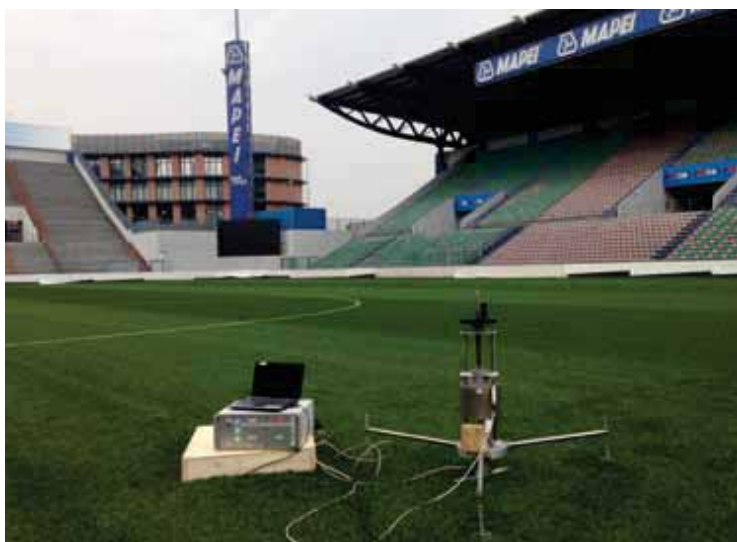
FOTO 1. Atleta di Berlino utilizzato per la caratterizzazione delle superfici sportive, in accordo alle raccomandazioni FIFA.
