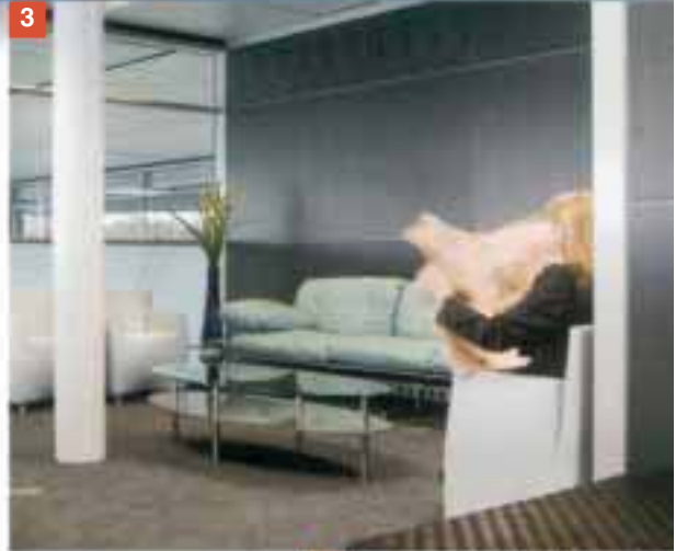
Foto 1. La galleria del vento. La pavimentazione di gres porcellanato nero è stata incollata con Granirapid e fugata con Kerapoxy nero.
