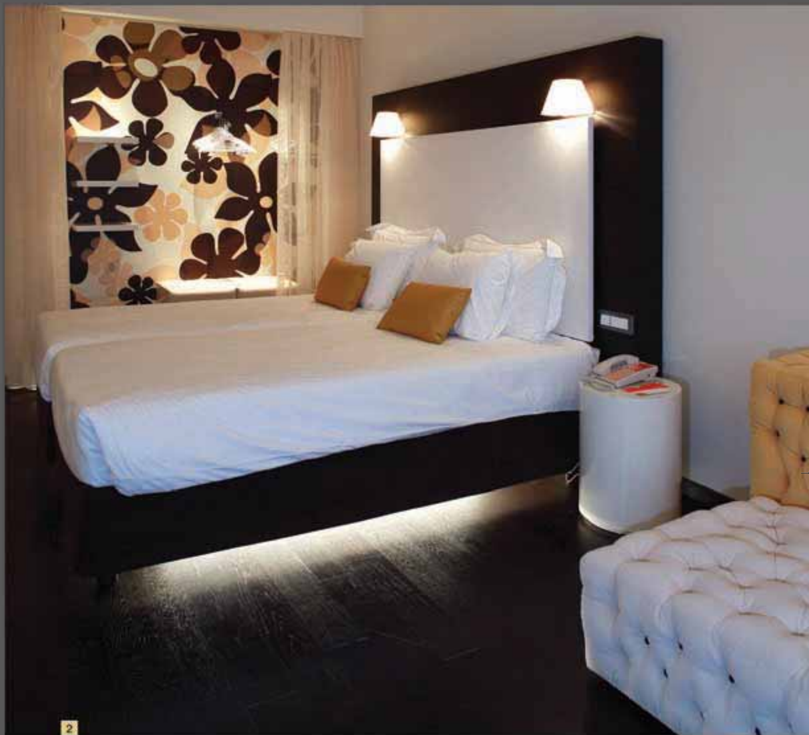
Foto 2. Le camere e le suite sono state pavimentate con parquet in rovere finitura noce scuro posato con Ultrabond P902 2K. Un particolare prezioso e originale: dei punti luce collocati sotto il letto creano suggestivi effetti di luce sulla pavimentazione.
