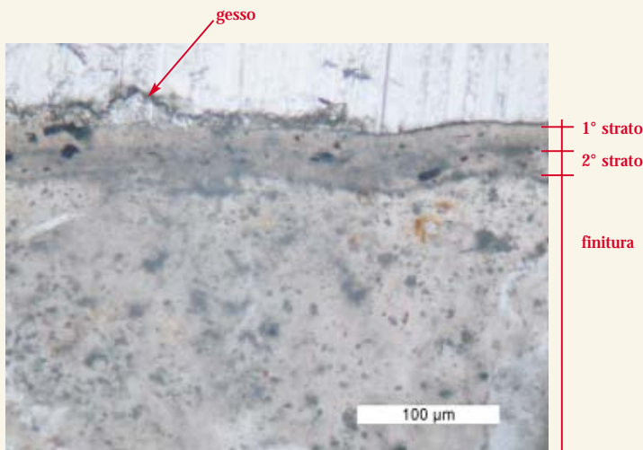
Sezione stratigrafica dell'affresco e della finitura sottostante. Dalla superficie verso l'interno si nota: 1) deposito superficiale discontinuo di gesso 2) manto pittorico costituito da due strati dello spessore di ca. 25 \mu\text{m} cad. 3) finitura.
