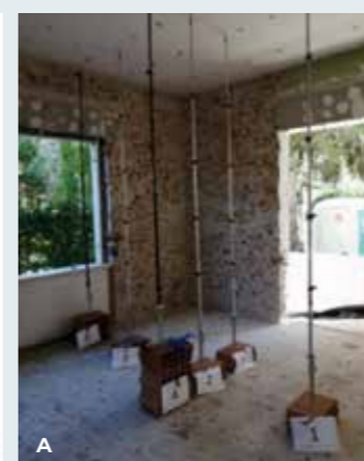
Fig. 2. Area della prova di carico e strumentazione al piano terra: a) pre-intervento; b) post-intervento.
